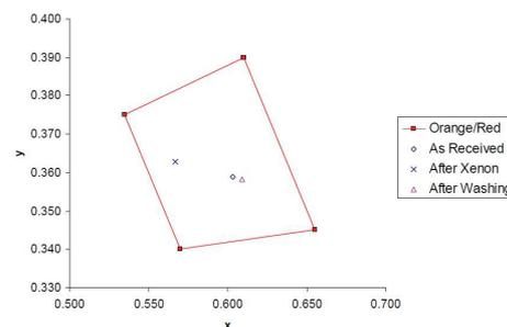
\* Test effettuato presso i laboratori COFRA con il metodo di prova definito dalla EN ISO 6330:2012, metodo 3N/F
