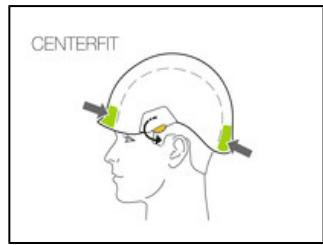
Le regolazione CENTERFIT mantiene il casco perfettamente centrato sulla testa, grazie alle due rotelle di regolazione laterali.
