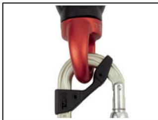
La forma ovale e simmetrica permette di posizionare il moschettoni in maniera ottimale. La barretta di posizionamento CAPTIV favorisce la sollecitazione del moschettone sull'asse maggiore, ne riduce il ribaltamento e lo rende solide con il dispositivo.
