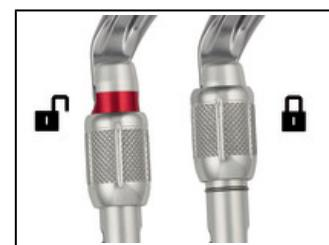
Per facilitare il controllo del materiale, i moschettoni con ghiera di bloccaggio manuale SCREW-LOCK sono dotati di un riferimento visivo di colore rosso, visibile esclusivamente quando la leva del moschettone non è bloccata.
