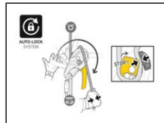
Il sistema AUTO-LOCK consente di posizionarsi facilmente sul posto di lavoro, senza dover utilizzare la maniglia e realizzare una chiave d'arresto: quando l'utilizzatore rilascia la maniglia, la corda è automaticamente bloccata nel dispositivo.
