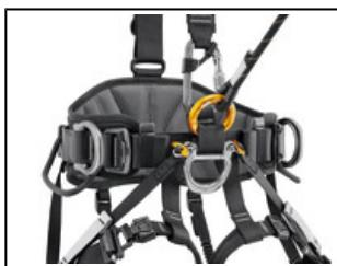
Punto di collegamento ventrale con un passante tessile (per l'installazione di un cordino mediante un RING OPEN) e una D metallica (per l'installazione di un sedile PODIUM o LITEPOD).
