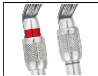
Per facilitare il controllo del materiale, i moschettoni con ghiere di bloccaggio manuale SCREW-LOCK sono dotati di un riferimento visivo di colore rosso, visibile esclusivamente quando la leva del moschettone non è bloccata.
