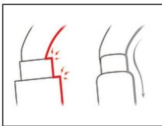
Il design interno fluido dei moschettoni Am'D riduce il rischio di punto stabile e facilita la rotazione del moschettone.
